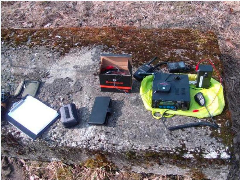
В качестве антенны попробовал приемную антенну Tecsun AN-03L. Длина тонкой ниточки составила 6,5м. Высота подвеса не более 2м.
