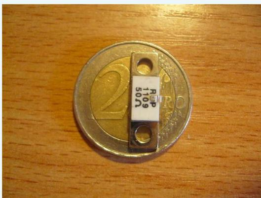
При очень скромном размере резистор способен держать солидную мощность в 100Вт. На фото резистор в сравнении с монетой достоинством в 2 Евро.
